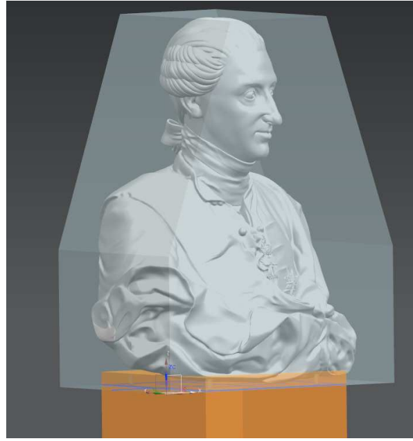
Imagen digital y tridimensional del Infante encajada en el bloque de mármol previa a su fresado
